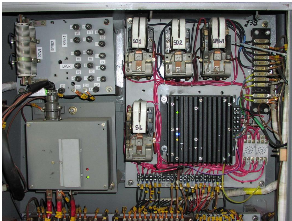
Regulator PROPT zamontowany w skrzyni aparatuowej za stanowiskiem prowadzącego
